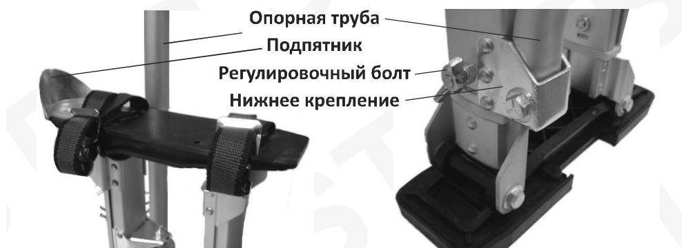
**ВАЖНО!** При вставании на ходули сначала затягиваются ремень для икры, а затем ремни стопы, причем один из ремней, ближний к пальцам, должен быть затянут в самом широком месте пальцев. После завершения работ на ходулях сначала отсоедините ремни стопы, а только потом ремень для икры.
